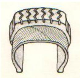
Estructura de un neumático radial
