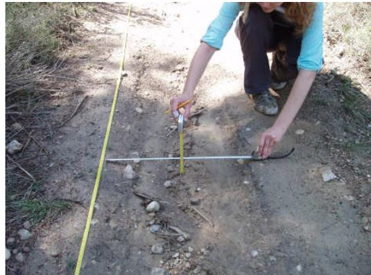
**Fig. 12. Proceso de medida de un surco**
